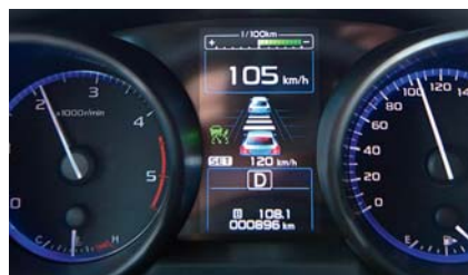
Guter Blick | Das Assistenzsystem Eyesight ist kamerabasiert und hält Abstand zum Vordermann
