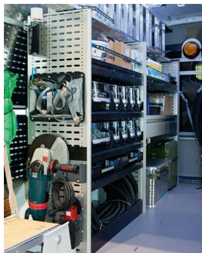
Material-Mix | Das Grundgerüst bleibt aus Stahl, die Böden sind aber aus Composite Material
