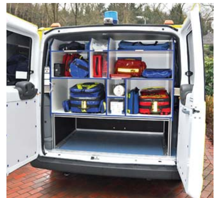
Rundum-Betreuung | Der Transporter ist umgebaut, damit das Equipment stets an seinem Platz ist
