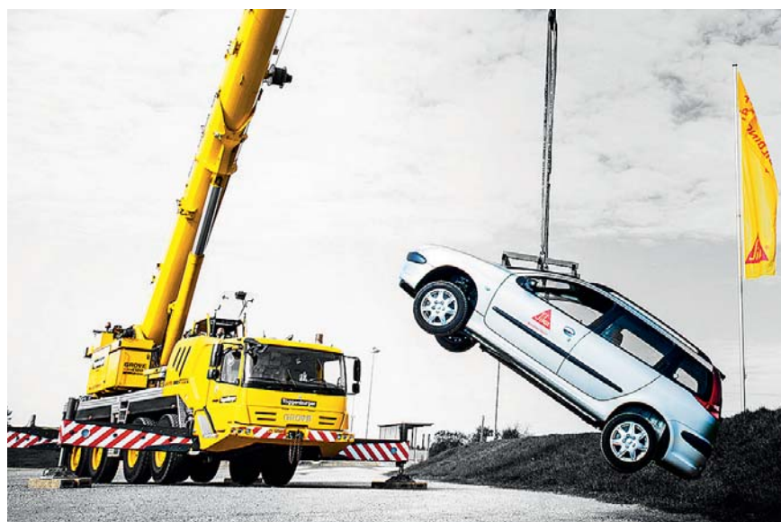
Härtetest | Ein neues Klebesystem macht die Scheibe binnen einer Stunde voll belastbar
