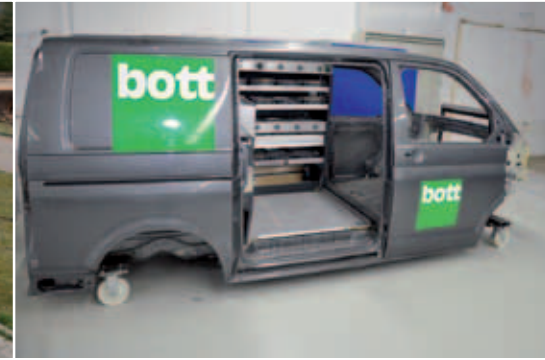
Schick: vario als Branding für die Schiebetür (li.). Belastbar: die Einrichtung nach dem Crashtest (re.)
