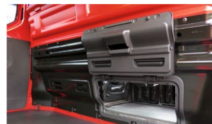
Lucke für lange Güter | Die Durchladeklappe im Franzosen bringt Spielraum für Überlanges
