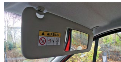
Versteckter Helfer | Der Totwinkelspiegel findet sich im Trafic in der Blende wieder
