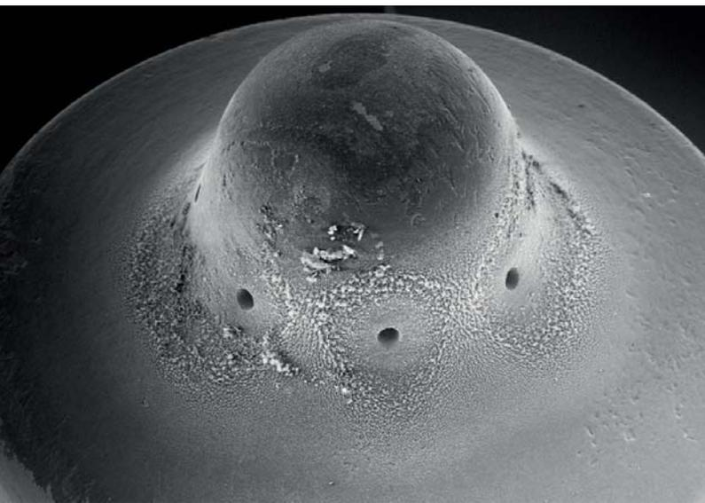
**Neu** | Im Rasterelektronenmikroskop sieht eine mit den neuen Kraftstoffen gereinigte Diesel-Einspritzdüse 65-fach vergrößert so aus
