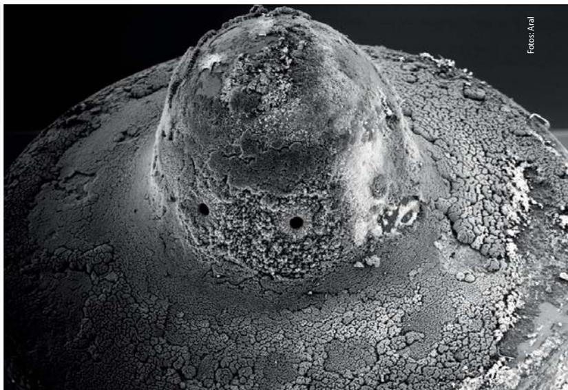
**Alt** | Im Vergleich zur gereinigten Düse wird deutlich, wie sehr Ablagerungen an einer verschmutzten Düse das Einspritzverhalten behindern können
