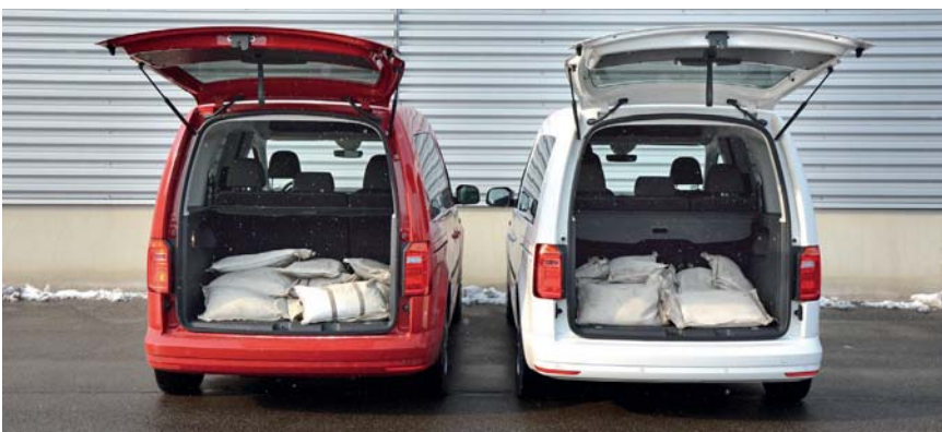
Wahre Größe | Der TGI (l.) fasst nur 410 Kilogramm Nutzlast, beim TDI sind es 605 Kilogramm
