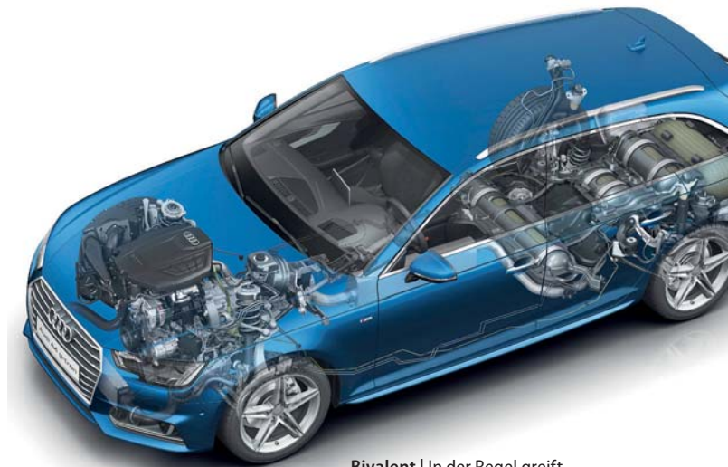
Bivalent | In der Regel greift der A4 Avant auf das CNG in den Tanks im Heck zurück
