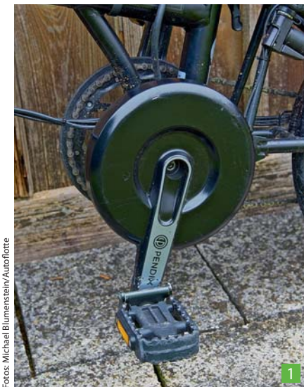
1 Im Tretlager ist der Antrieb versteckt 2 Per Knopfdruck lässt sich die elektrische Unterstützung ein- und ausschalten 3 Mit einem Klick kann der Akku entfernt und aufgeladen werden
