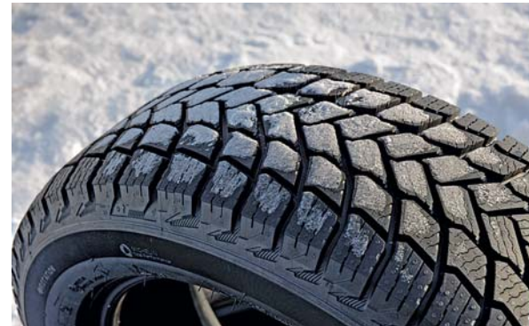
Je weicher das Gummi, desto besser die Verzahnung mit Schnee und Eis
