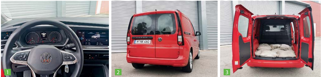
1 Neues Cockpit mit wenigen Knöpfen 2 Die neuen Heckleuchten stechen hervor 3 Rund 700 Kilogramm Zuladung sind erlaubt
