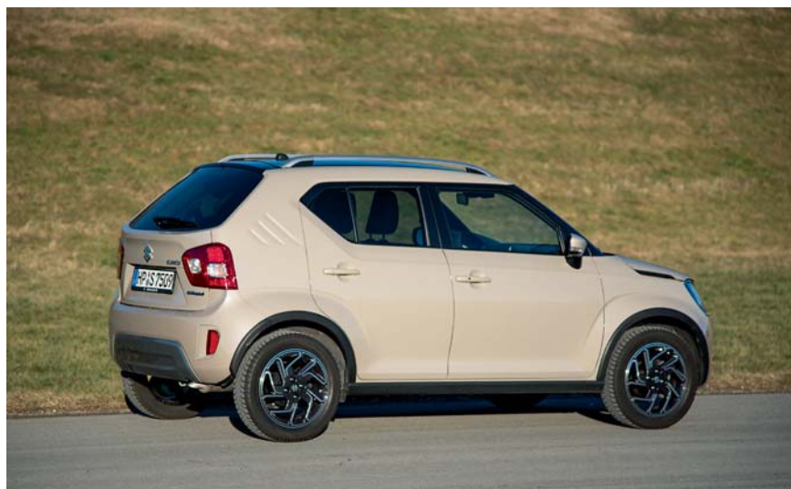
Die breite C-Säule schränkt die Sicht nach schräg hinten ein. Der große Heckwischer macht dafür die Sicht nach hinten sauber, die Rückfahrkamera hilft beim Parkieren
