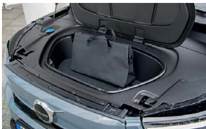
Vorn gibt es einen Frunk fürs Ladekabel oder andere Kleinigkeiten. Das Frontlogo ist beheizt. Warum? Darunter sitzt der Radarsensor und der soll auch bei Schnee funktionieren
