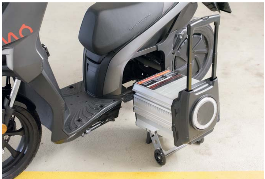
Clever: Der Akku wird zum Laden wie ein Koffer mit ins Büro oder nach Hause genommen. Oder es wird direkt via Kabel an der Garagensteckdose geladen – sechs bis acht Stunden
