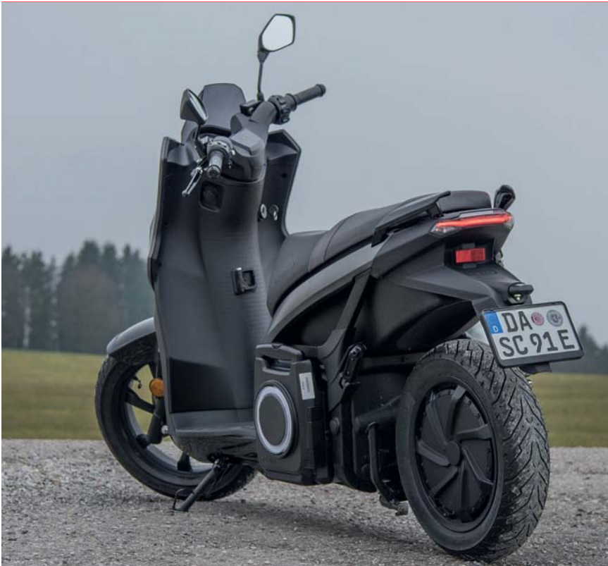
Im Hinterrad ist der E-Motor installiert und hat „ausreichend“ Kraft
