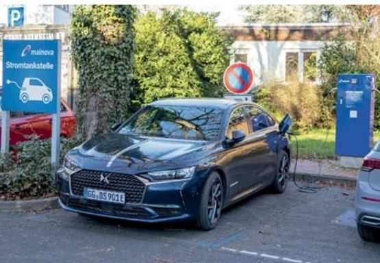
**Geladen werden alle DS 9 E-Tense einphasig mit maximal 7,4 kW. An den meisten Ladesäulen/Wallboxen in Deutschland tröpfeln aber weniger als 4 kW rein. Dann dauert der Ladevorgang für 40 Kilometer Reichweite bis zu fünf Stunden**
