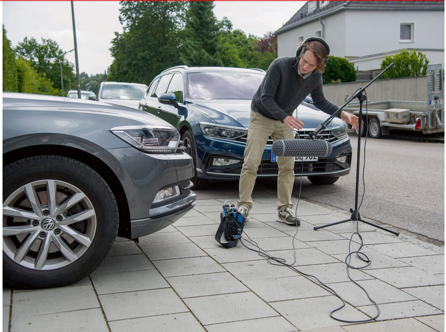
Mit Mess-Equipment werden die Außengeräusche aufgenommen. Der Unterschied ist aber auch ohne hörbar. Der alte TDI mit 150 PS klingt weicher.
