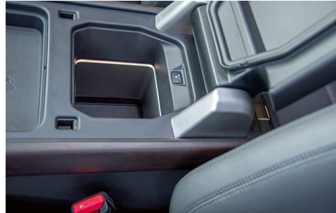
Auf Wunsch wird im Kühlschrank unter der Mittelarmlehne vorn schockgefrostet.
