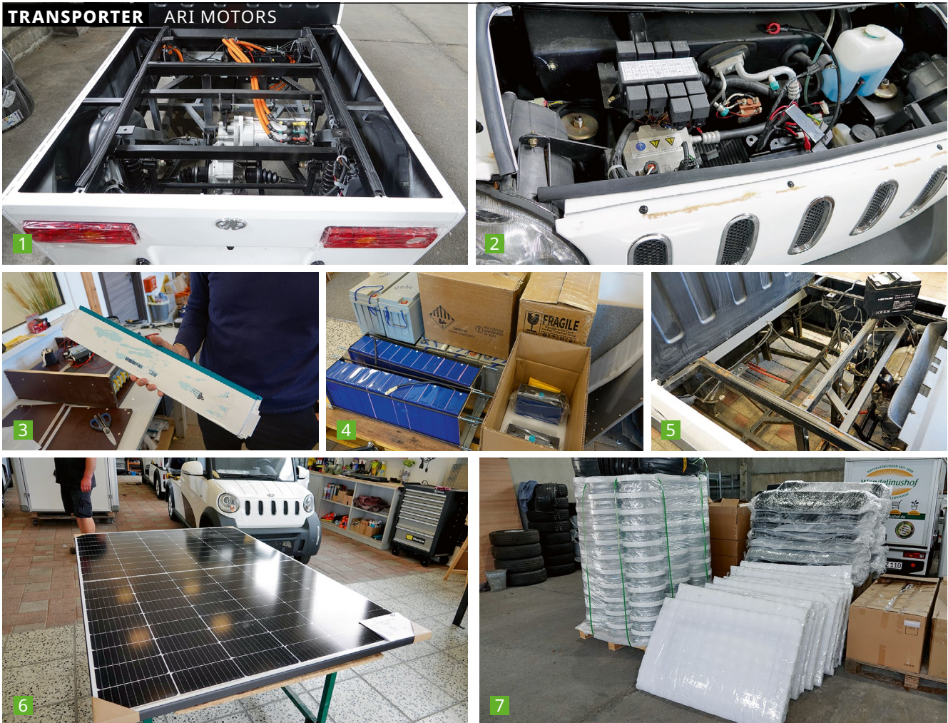
1 Von den importierten Fahrzeugen werden das Chassis und die Antriebstechnik übernommen, dann folgen Umbauten. 2 Die maximale Leistung legt die Zugehörigkeit zur L7e-Klasse fest: 15 kW/20 PS. 3 & 4 Die Art der Batterien und damit die Reichweite der Fahrzeuge kann der Kunde mitbestimmen. 5 In Handarbeit wird aus dem Importfahrzeug ein Ari gemacht. 6 Eine der Optionen heißt Solardach. 7 Ersatzteile sollen binnen 48 Stunden in der Kunden-Werkstatt sein.
