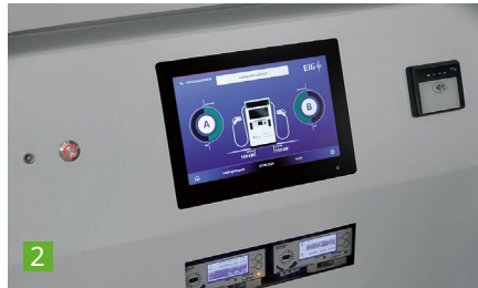
1 Mit dem kleinen Display wird Flexpole bedient, im oberen läuft auf Wunsch Werbung. 2 Hier wird die aktuell mögliche Ladeleistung angezeigt, werden links 150 kW genutzt, kommen rechts maximal 100 kW raus. 3 Die neue Elli-Wallbox.
