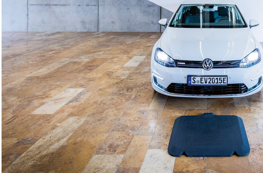
Eine Bodenplatte und ein Empfänger am Auto sind Voraussetzung für induktives Laden.
