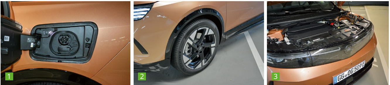
1 Geladen wird mit 11 (AC) oder maximal 160 kW (DC). 2 Die Optik, etwa mit den optionalen 20-Zöllern, stimmt beim Grandland. Das Fahrwerk ist komfortabel eingestellt. 3 Die 157 kW Leistung des E-Motors ist durchaus ausreichend.
