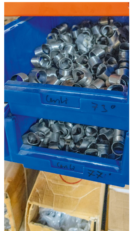
Bei Patria werden nach wie vor Muffen beim Rahmenbau verwendet.
