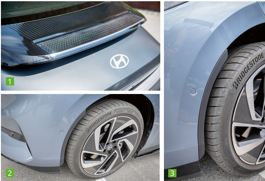
1 Um die Luftwirbel ums Auto leiten zu können, sind gerade Spoiler wichtig, da das Heck für viele Verwirbelungen sorgt. 2 & 3 Air Curtains leiten den Wind sauber um die Vorderräder und bringen ihren Beitrag zum niedrigen cw-Wert.
