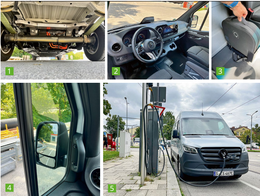
1 Motor vor der Hinterachse, Federn aus Glasfaserkunststoff. 2 Wertiges und übersichtliches Ambiente. 3 Halter fürs Ladekabel neben dem Fahrersitz. 4 Störende Stege in den Seitenfenstern. 5 Laden mit maximal 115 kW (Option).
