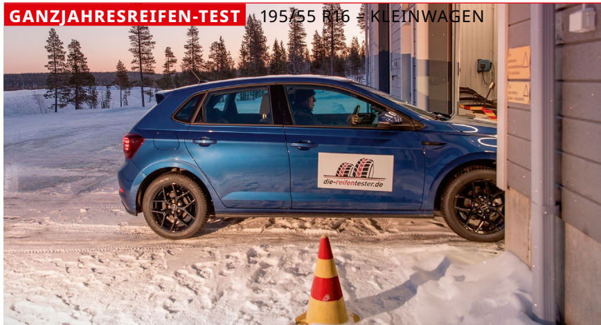
Alle Reifen wurden stets auf demselben Fahrzeug (hier VW Polo 1.0 TSI) und denselben Borbet-Alufelgen im Y-Design getestet.
