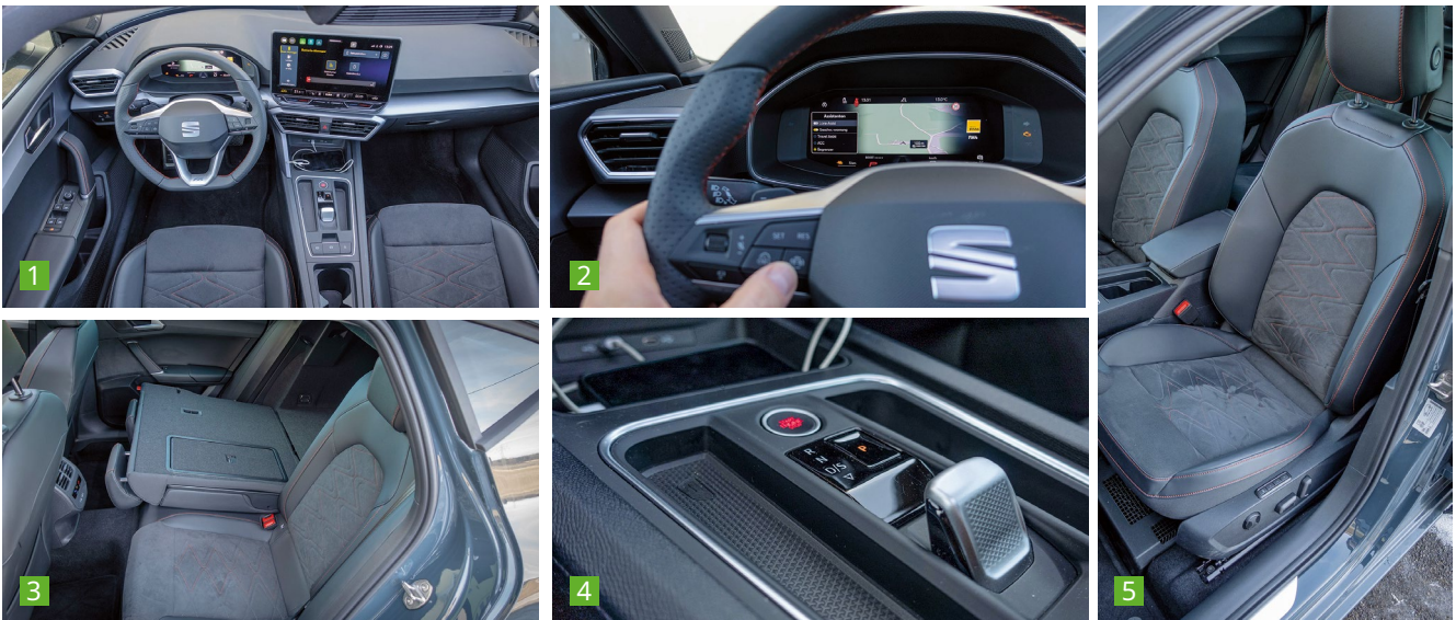
1 Das Cockpit ist im Prinzip nur in Nuancen angepasst. Vor allem das Infotainmentsystem (MIB4) hat bei der Bedienfreundlichkeit zugelegt. 2 Klacklack und schon ist der Tempobimmler aus. 3 Wer umlegt, erhält beim Phev eine fast ebene Ladefläche, die 40:60 teilbar ist. 4 Durchblickt jeder – die Schaltlogik. 5 Da sitzt es sich gut - Leder gibt es nicht.
