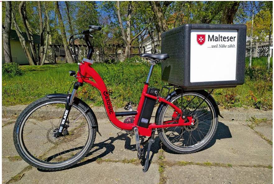
Das Velosic Pelic 3 mit 250-Watt-Motor ist wartungsarm und robust aufgebaut.
