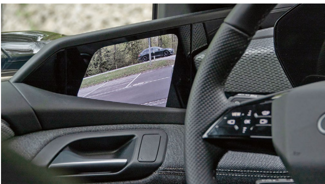
Kameras anstelle von Seitenspiegeln und zwei Monitore innen im Audi. Entfernungen abschätzen wird schwieriger.
