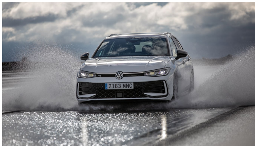
Konstant sieben Millimeter beträgt die Wassertiefe beim Längs-Aquaplaning.
