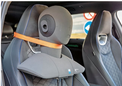
Ein Kunstkopf nimmt die Störgeräusche im Fahrzeug bis ins Detail auf.
