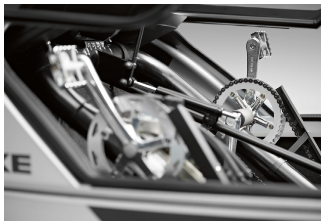
Tretkraft kombiniert mit E-Motor und 40-kWh-Akku.
