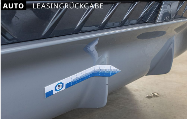
Vermerkt wird wirklich alles, berechnet nur das, was dem Schadenkatalog entspricht. Diese Macke im Diffusor nicht.
