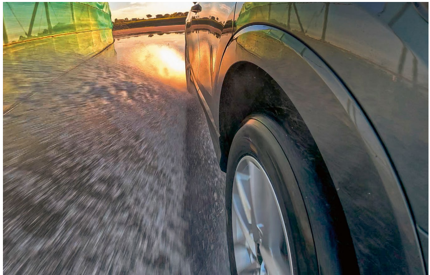
Im Queraquaplaning-Becken (7 mm tief) ist bei rund 80 km/h Schluss mit Haftung.
