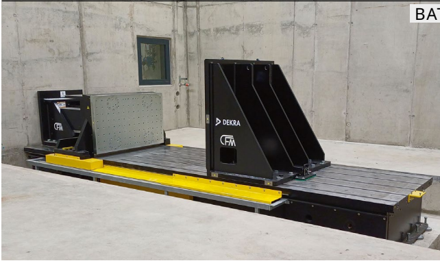
Was passiert bei Unfällen mit den Akkus? Hier in der Quetsche wird der Extremfall simuliert.
