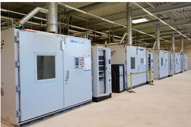
Ab in die Klimakammern. Extreme Temperaturen dürfen den Akkus nicht allzu viel ausmachen. Klappt das?
