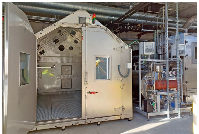
Hier geht es um die Langlebigkeit der Akkus. Rost, also die Korrosion, steht in dieser Kammer im Mittelpunkt.
