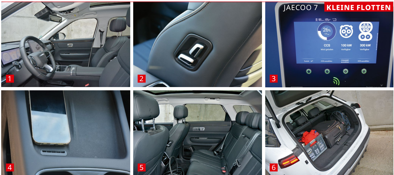
1 Wie bei fast allen Chinaautos, die es nach Europa schaffen, ist die Materialauswahl gelungen. 2 Kleiner Luxus ohne echten Nutzen: die Chauffeurjustage des Beifahrersitzes vom Fahrersitz oder Fondbereich aus. 3 Der Jaecoo 7 kann CCS-Laden. Das ist jedoch sehr teuer und daher nicht marktrelevant. 4 Das Handy wird beim Induktivladen belüftet. 5 Die Rückbank ist verschiebbar ... 6 ... und erweitert das Ladeabteil von schmalen 324 auf mehr als 500 Liter Volumen.
