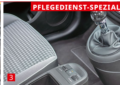
1 „Handgerissen“ geht es durch sechs Vorwärtsgänge, keine Automatik. 2 Die Sitze sind für den Cityeinsatz perfekt. 3 Ablage in der Mittelkonsole, Lautstärkeregelung und Deaktivierbarkeit der Start-Stopp-Funktion per Walze/Wippe.
