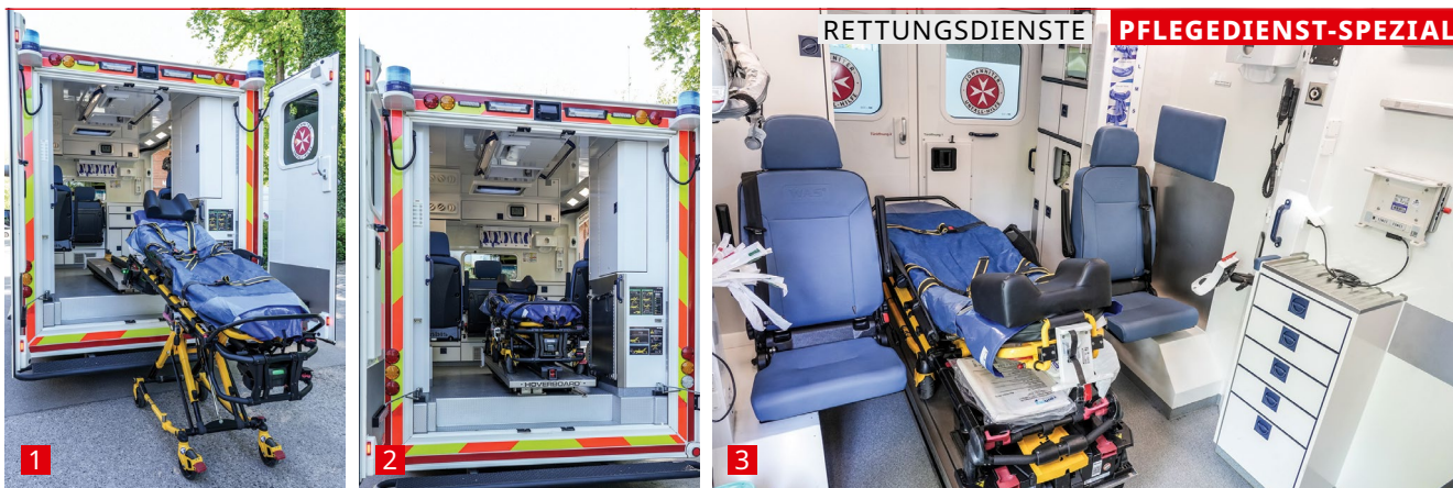
1 bis 3 Der RTW BY 2025 basiert auf dem Mercedes-Benz Sprinter mit speziellem Kofferaufbau. Er ist 6,55 Meter lang und bietet eine Stehhöhe von 2,86 Metern. Moderne Notfalltechnik gibt es ebenso wie spezielle LED-Lichtsysteme.
