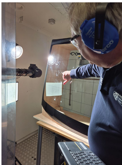
Per Luftdruckgewehr werden Steine auf die Frontscheibe geschossen.
