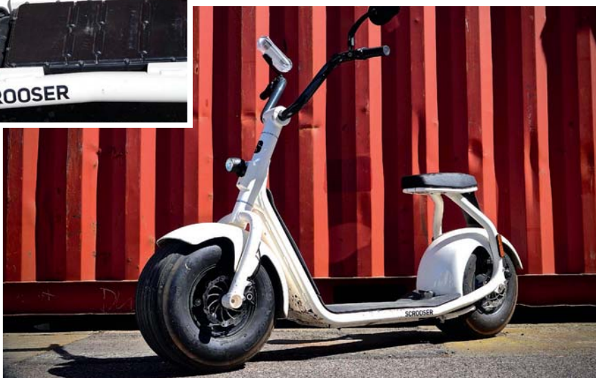
Der Scooser rollt auf dicken 8-Zoll-Reifen und steht auch mal ohne Ständer
