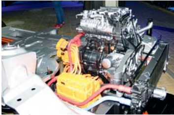
Range Extender: Der Benziner produziert Strom für den E-Motor
